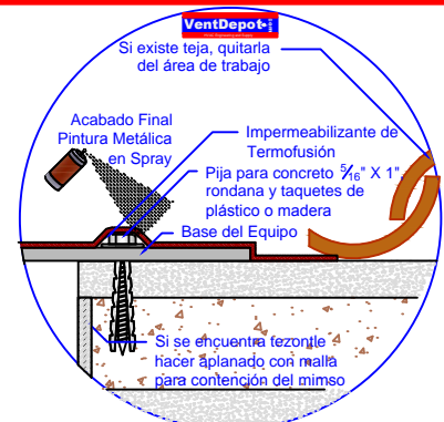
3. Realizar Anclaje en base a Detalle
