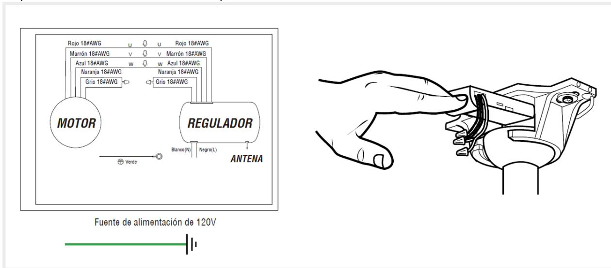
Para ventiladores de barra, deslice la cubierta de control electrónico hasta el soporte de montaje.
