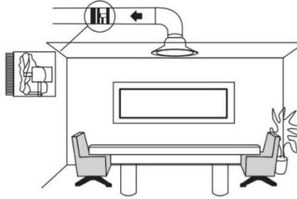
Reposición de aire fresco ó descarga directa a exterior
