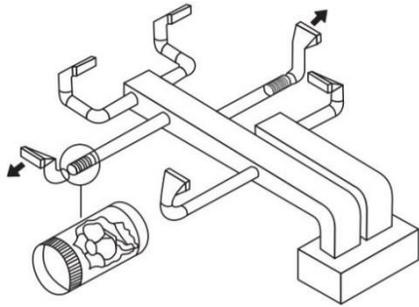
Extracción o inyección por conducto individual.
