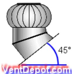
El corte helicoidal, con el que cuenta el TurboExtractor, permite que se adapte a una inclinación de techo de hasta 45°.
