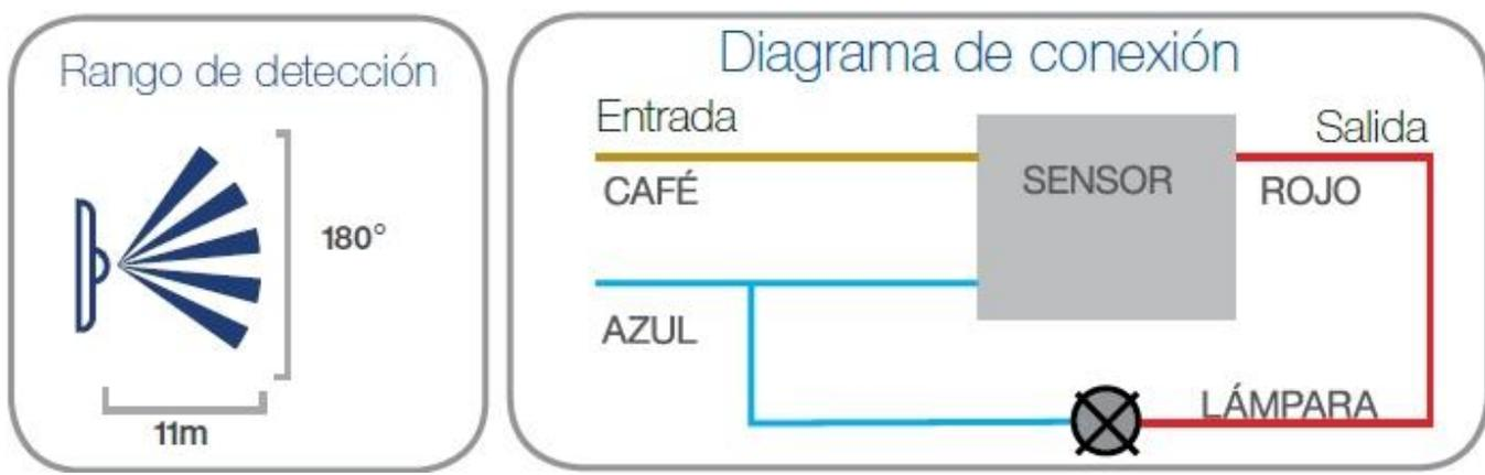
**Diagrama de Conexión del Sensor de Movimiento SensoRex**
