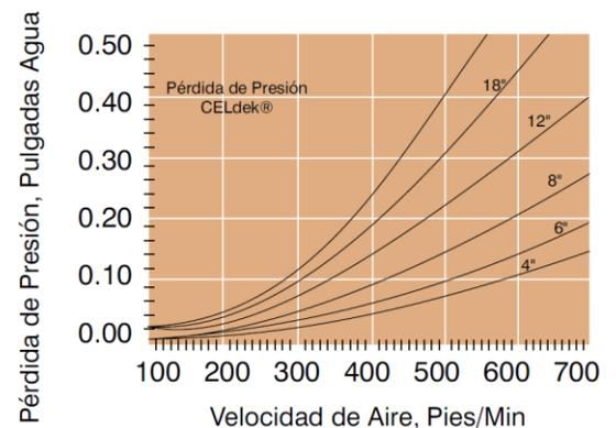
La Caída de Presión Estática a 2 a 2.5 m/s (400/500 pie/min) Velocidad, es de 0.40 inmg@400ppm ó 10.16 mmca@400ppm.
