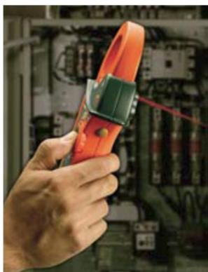
Las Pinzas Amperimétricas Tucan800, con termómetro IR integrado y puntero láser es excelente para solucionar problemas y localizar puntos calientes de motores que se sobre calientan.
