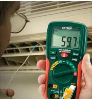
Función de temperatura tipo K, en el modelo MXMPT-002
