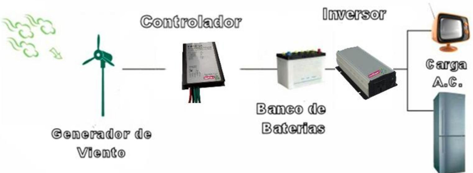
**Aplicaciones de Generación eléctrica: Generador eólico Horizontal, CoreKit.**
