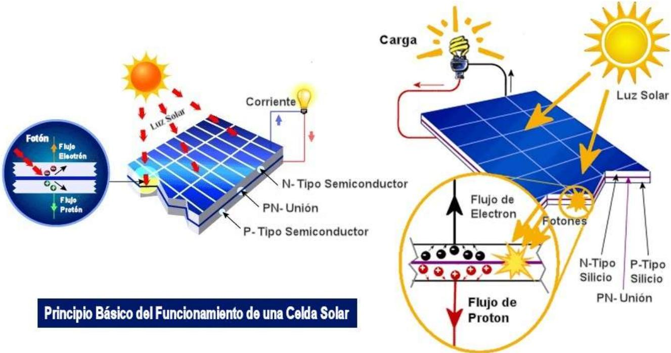
**Principio Básico del Funcionamiento de una Celda Solar**
