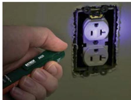
El Detector de Voltaje RangPen tiene linterna integrada.
