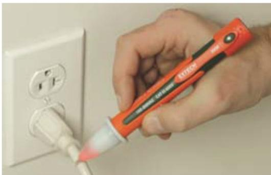
Determina rápidamente la presencia de cables con corriente, antes de la prueba.
