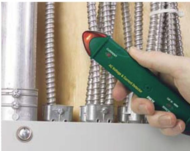
El Detector CurrentPen está diseñado para Comprobar la tensión en los interruptores
