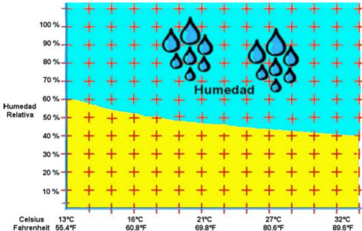
No se deberá utilizar el Deshumidificador TopDry si su requerimiento de % de Humedad Relativa Vs Temperatura cae en la zona amarilla, en caso de caer en la zona amarilla se deberá utilizar un Deshumidificador Desecante
