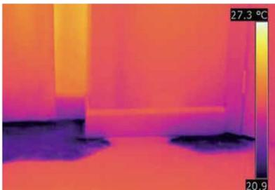
Filtración de humedad en el suelo, imposible de ver a simple vista, pero visible con claridad con infrarrojos.
