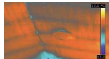
Imágenes infrarrojas tomadas del mismo techo. En la imagen de la izquierda, la temperatura de la habitación ha cambiado por la calefacción, lo que hace que la humedad en el aislamiento aparezca claramente.
