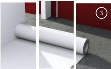
3.- Ya seleccionada el área donde instalará su nuevo piso calefaccionado con CellHeat A para pisos secos, proceda a colocar el bajo alfombra (polifoam) que normalmente se pone en la mayoría de las marcas de piso laminado. Este deberá cubrir toda el área donde colocará el laminado, y no deberá estar encimado en las uniones, mismas que deberá pegar con cinta adhesiva de su preferencia, tales como: Masking Tape, Cinta Gris, etc.... ).
