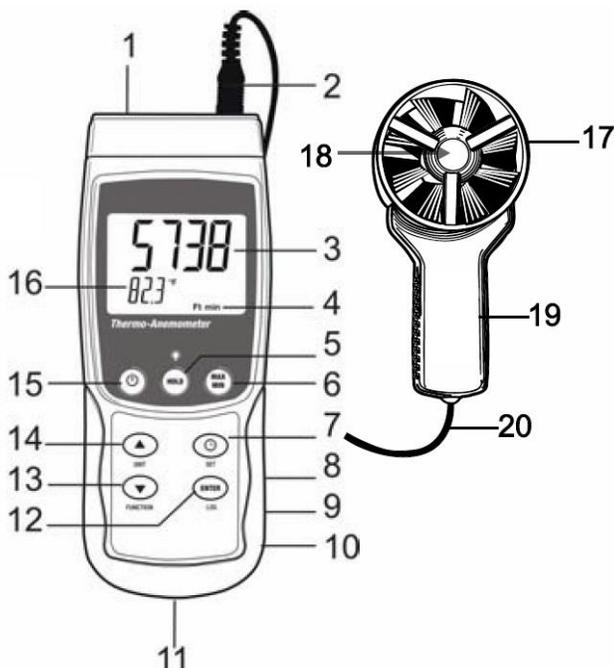
Nota: El compartimento de la batería, soporte inclinado y montaje para trípode se encuentran atrás del instrumento; los artículos 8, 9 y 10 se encuentran detrás de la tapa del compartimento a la derecha del medidor.
