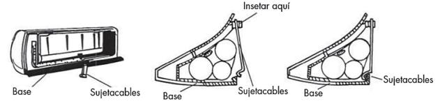
Conecte el sujetacables en la ranura
