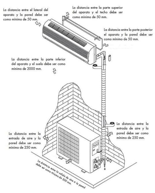
El grafico anterior es solo una representación del aparato y pudiera no coincidir con la apariencia del aparato que ha adquirido. La instalación deberá ser efectuada por personal calificado y de conformidad con la normativa vigente sobre instalación de equipos eléctricos.
