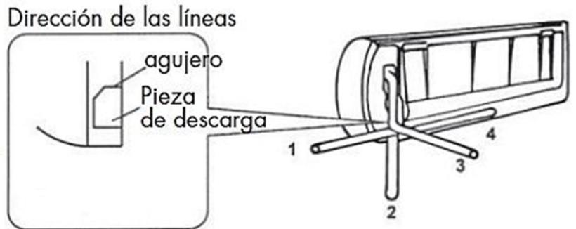
**Nota:** Cuando instale las líneas siguiendo la dirección 1, 2 o 4, recorte la correspondiente pieza de descarga que sobresale de la unidad interior.
