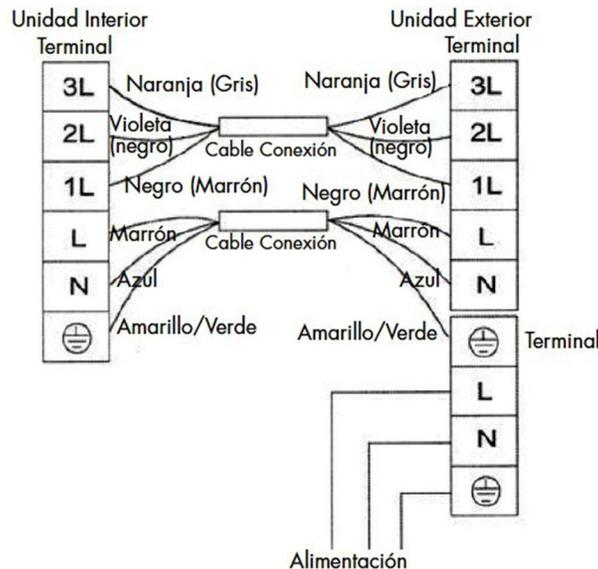
En estos modelos, la alimentación se efectúa desde la unidad exterior mediante un disyuntor.
